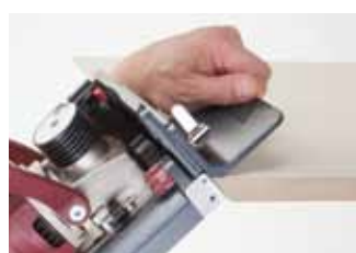
Exterior flush mitre joints
