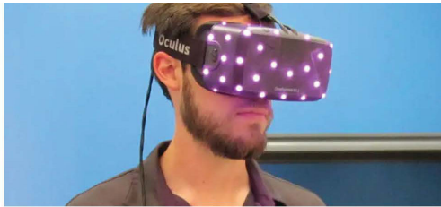
IR leds (Photo: ifixit.com)
