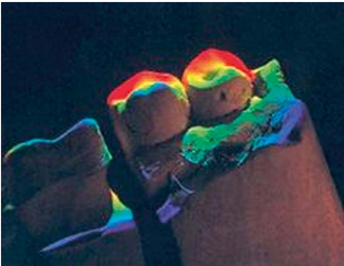
Figure 15. Mesure d'empreinte par profilométrie chromatique (Système Pro50) (A, B).
