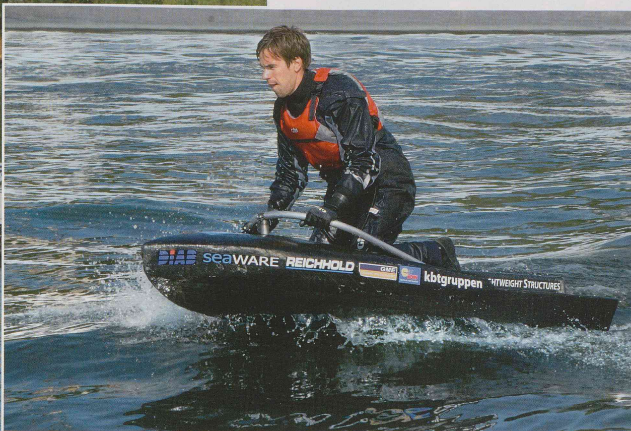
Evolu är en bärplansburen vattenleksak som drivs av en 4 kW elmotor och 16 stycken 3V-battericeller. Mått 2,31 x 0,7 meter. Längst ner på den 80 cm långa "kölen" sitter de två bärplanen.
