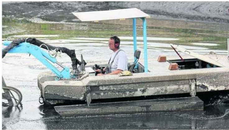
Mit den Bewegungen einer Amphibie: Eckhard Funck reinigt fahrend und schwimmend den Klärteich in Mecklar mit einer neuen und umweltfreundlichen Technik. Sein froschartiges Gerät leistet 60 Pferdestärken. Foto: Kaschik
