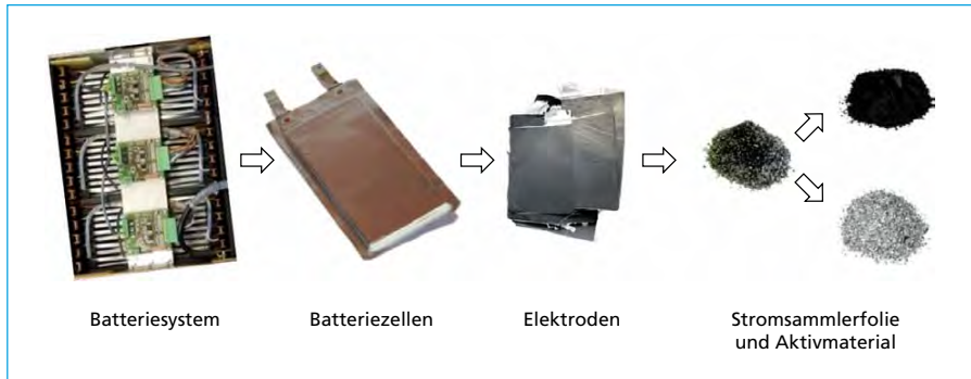
Bild 3: Mechanische Demontageebenen einer Lithium-Ionen-Batterie
