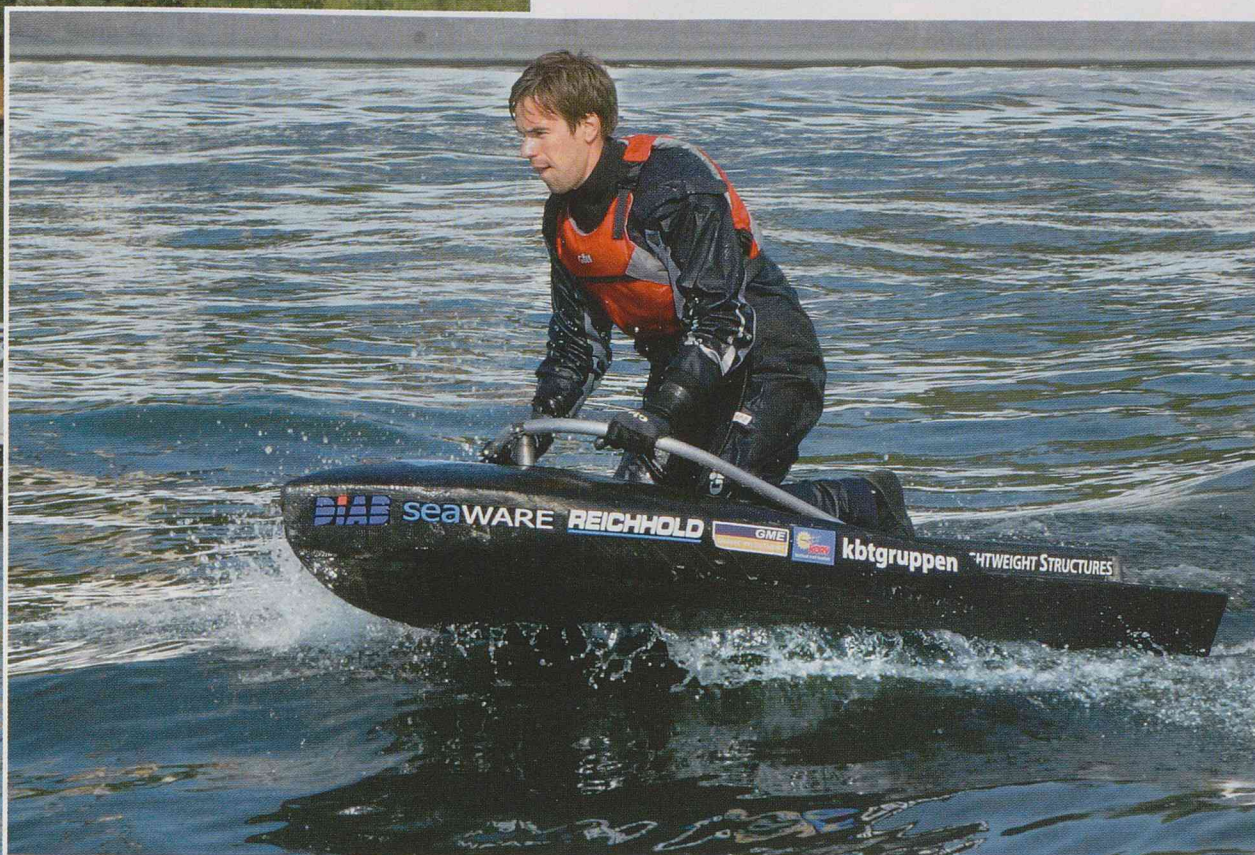
Evolu är en bärplansburen vattenleksak som drivs av en 4 kW elmotor och 16 stycken 3V-battericeller. Mått 2,31 x 0,7 meter. Längst ner på den 80 cm långa "kølen" sitter de två bärplanen.
