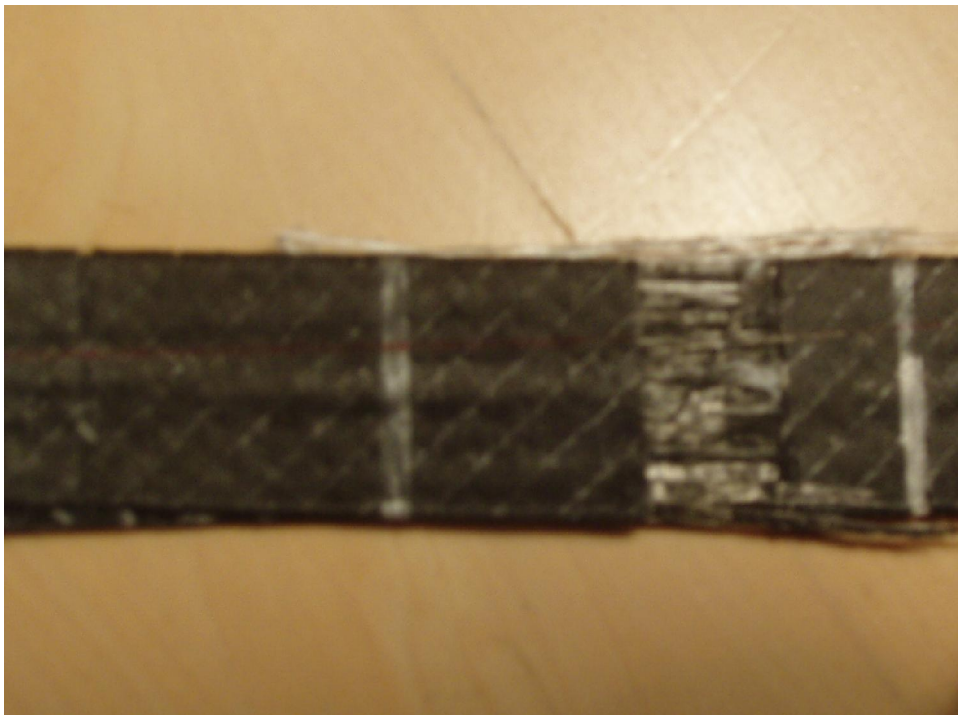
Figur 2. Typisk brott vid dragprovet.
