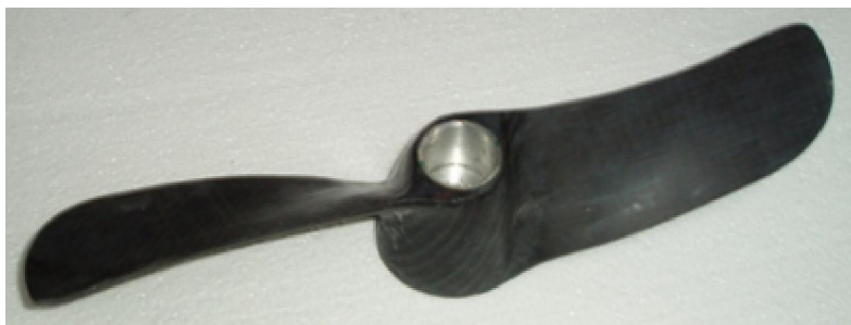
Figur 9 Propeller tillverkad för Evolo
