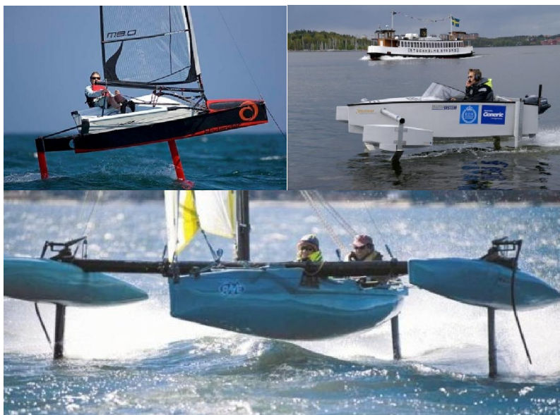
Figur 3. Skrovformer på andra vattenfarkoster med bärplanslösning.
