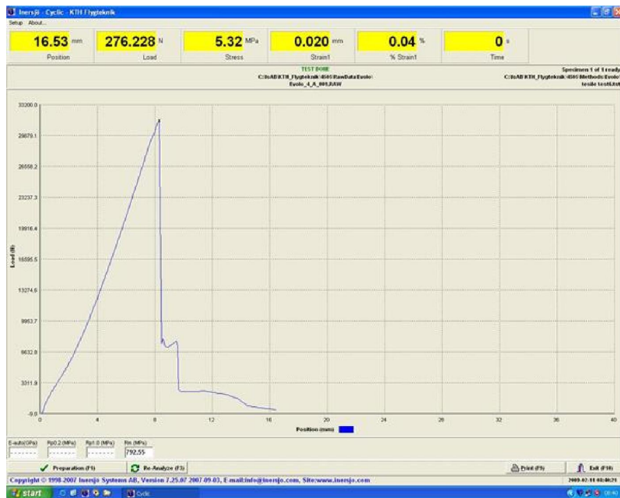
Figur 1. Typisk dragprovskurva från dragprovet. Vid låg belastning kan man se att glidning förekommer i och med att lutningen inte är linjär.
