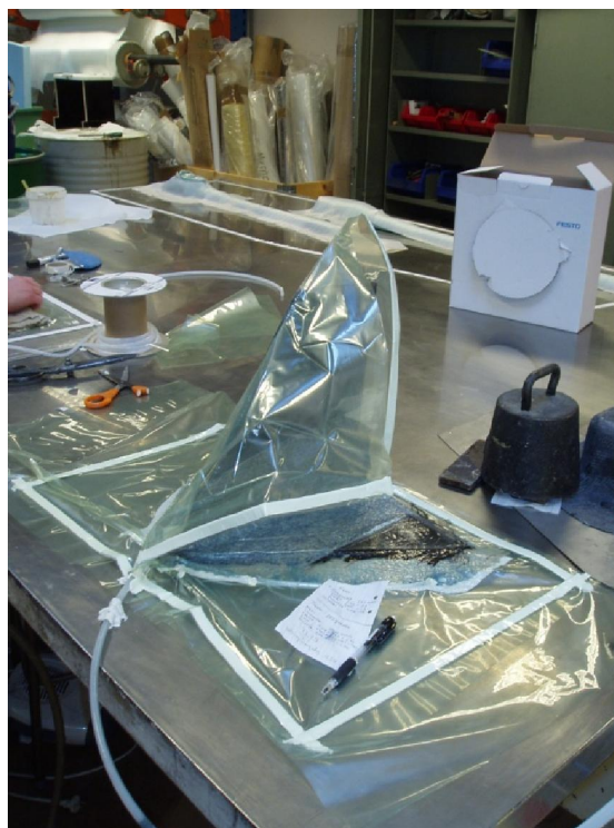
Figur 11 Vakuuminjicering av aktré bärplan med stabiliseringsvinge
