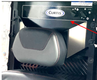
Air Conditioning Unit.
