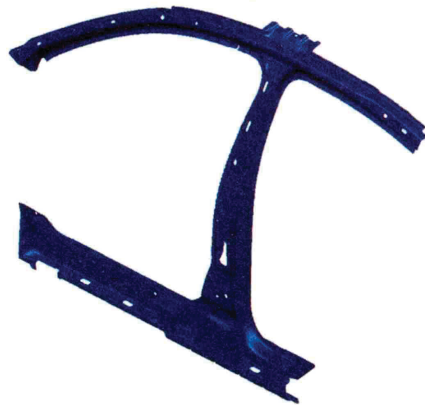
Abb. 9: Warmumgeformte Bauteile aus USIBOR 1500 P im VW Passat (Quelle: VW)
