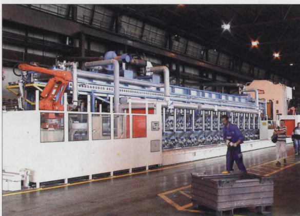
Bild 1: Presshärteanlage für B-Säulen eines Groß- serien-Pkw
