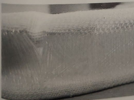
Unterschiedliche Dicken in einer gewirkten Abstandsstruktur, um z. B. Ränder höher zu gestalten
