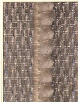
Figur 2. Jämförelse mellan två sömhälvor med gammal och ny teknik.
