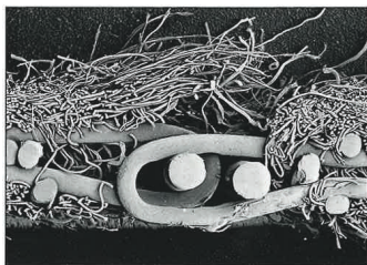
Fig. 8. Söm i begagnad filt av äldsta utförande. En fyllnadstråd lika instickstråden syns. Vaddfibrerna är endast förankrade så långt tvärtrådar finns.
