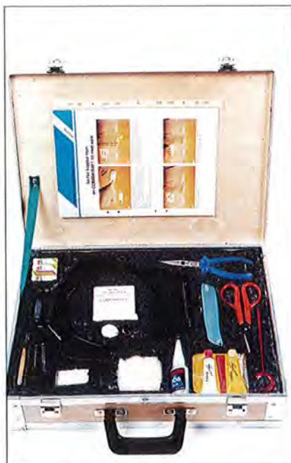
Den enkla lådan som hjälper operatören att koppla en filt med söm.
