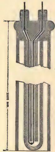
FIG. 1-6. — The Le Chatelier Thermo-Element.
