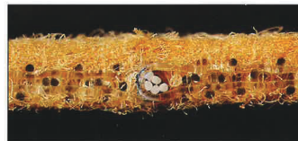
Fig. 10. Avancerad söm med fiberförankring också på öglorna enligt patentsökt förfarande.
