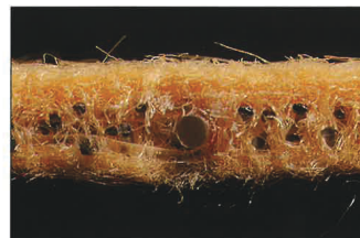
Fig. 5. SEAMTECH med dubbellagrad, symmetrisk basväv som ger lika tryckfördelning på båda sidor.
