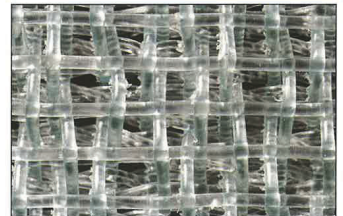
Fig. 6. Osymmetrisk, trelagrad basväv för SEAMTECH med jämnare tryckfördelning på översidan. Sömmen görs i den dubbellagrade underdelen av väven.
