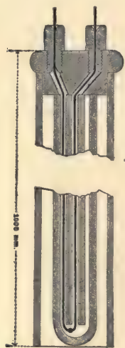
FIG. 1-6. — The Le Chatelier Thermo-Element.
