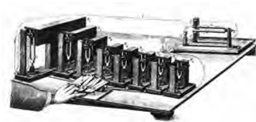
Figure 3.2 Apparat zur künstlichen Zusammensetzung der Vocalklänge as developed by Hermann von Helmholtz (Pisko 1865, 22).
